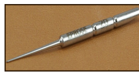
Hierro de lezna redonda amovible 20 mm y balo 20 mm
