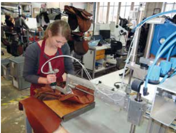
Pression avec une pince manuelle -45,5% Pression avec la pince pneumatique
